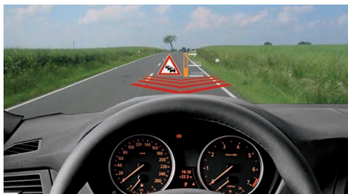
Abb. 2: Schematische Abbildung der eingeblendeten Straßenmarkierungen
