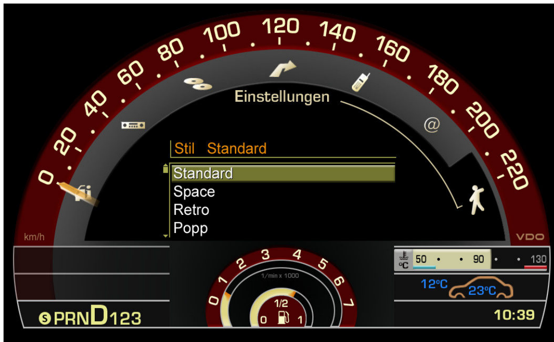
Abb. 5: Beispiel für ein Instrumentendesign mit rekonfigurierbaren Inhalten
