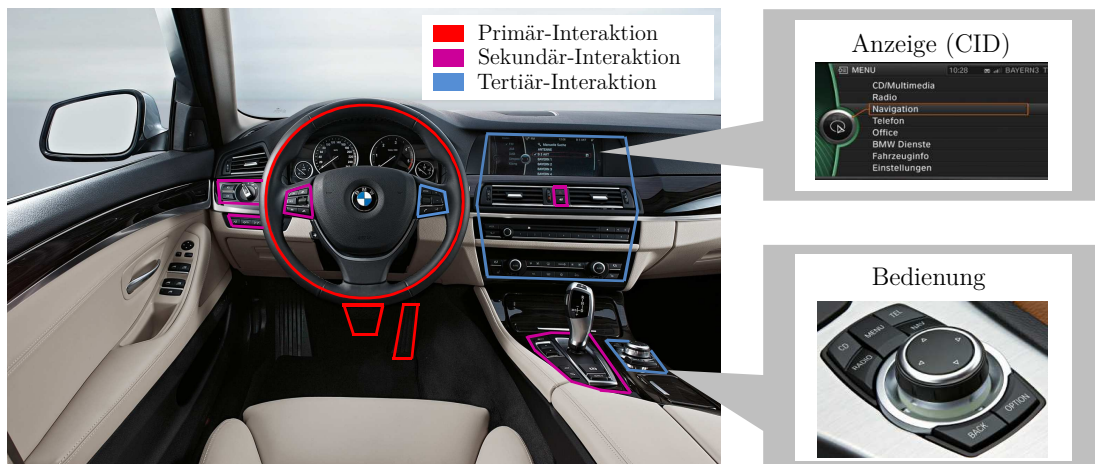
Abbildung 2.1: Bedien- und Anzeigebereiche für die primäre, sekundäre und tertiäre Fahrzeuginteraktion (Quelle Bilder: BMW Pressclub)
