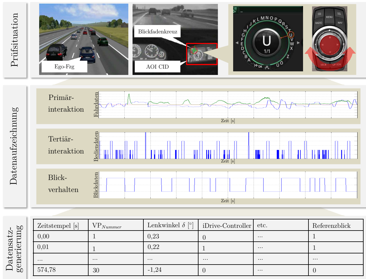
Abbildung 4.3: Streckendesign der Prüfsituation, Dikablis Onlinebild mit Blickfadenkreuz und Spellermenü zur Navigationseingabe (oben), zeitsynchrone Datenaufzeichnung der Fahr- und Blickdaten (mitte) und Zusammenführen aller Probanden in einen Datensatz (unten)
