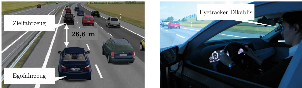
Abbildung 5.5: Egofahrzeug und Zielfahrzeug in der Prüfsituation (links), Proband mit dem Eyetracker Dikablis (rechts)
