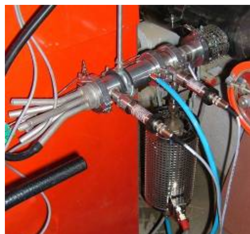
Abbildung 5-7: Dekati FPS 4000 Probenahmeeinrichtung im Einsatz.
