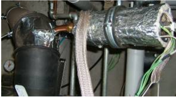
Abbildung 5-13: Beheizter JohnAS II-Impaktor während einer Messung.
