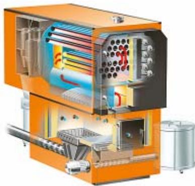
Abbildung 3-8 Unterschubfeuerung und zweizügiger Wärmeübertrager. [20]
