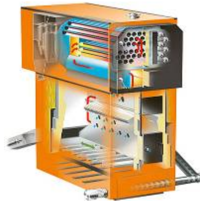
Abbildung 3-9 Flachvorschubrostfeuerung mit zweizügigem Wärmeübertrager [20].
