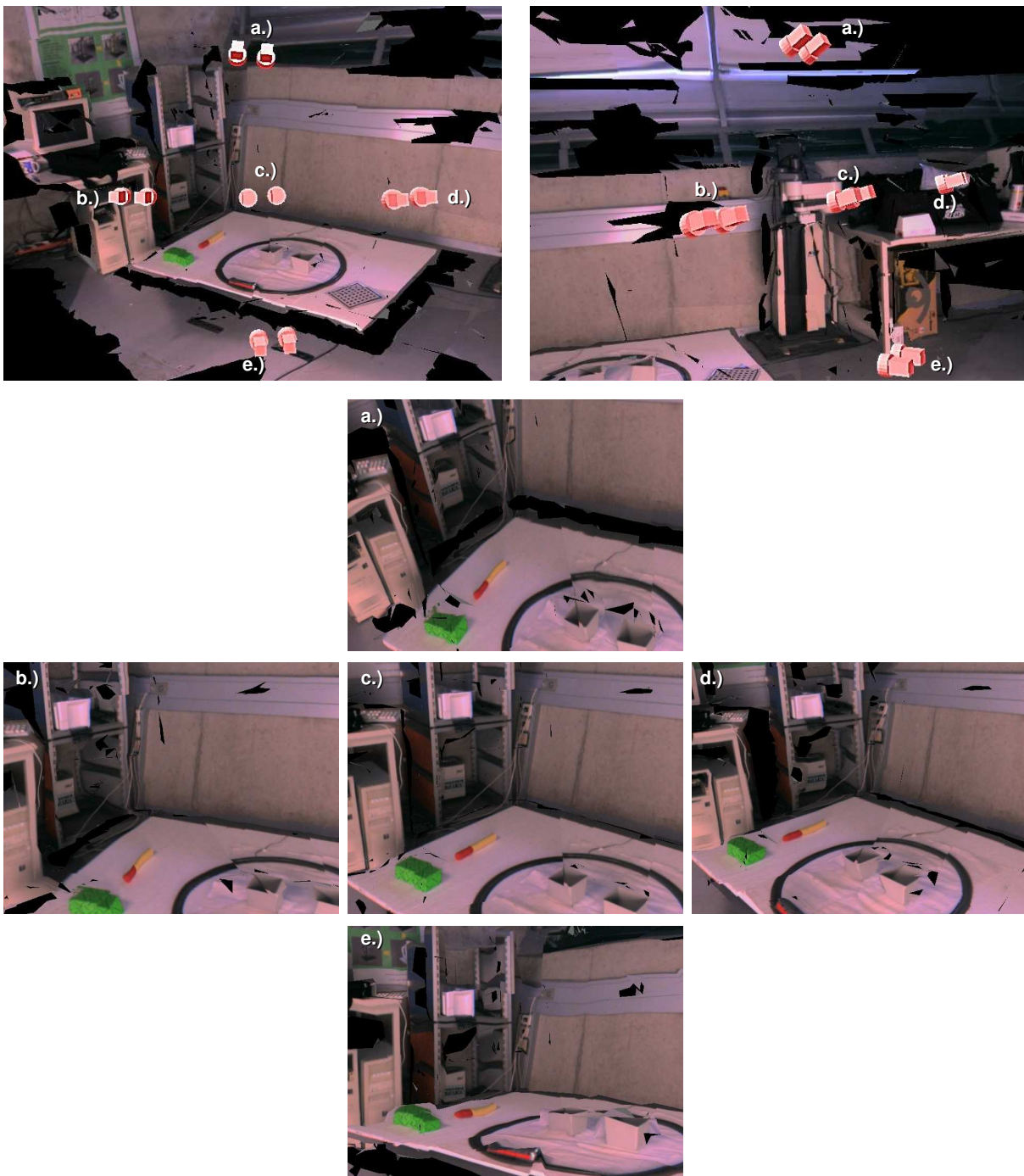
Abbildung 6.10: Texturiertes Modell der Testserie 2 aus fünf für die Telepräsenz realistischen Positionen betrachtet. Die obere Reihe zeigt die Kamerapositionen – sie befinden sich jeweils in einem Abstand von 1 m rund um die mittlere Position.
