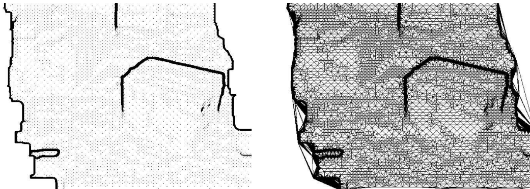
Abbildung 4.19: Resultierende Eckpunkte der adaptiven Triangulierung und das dazugehörige Dreiecksnetz.
