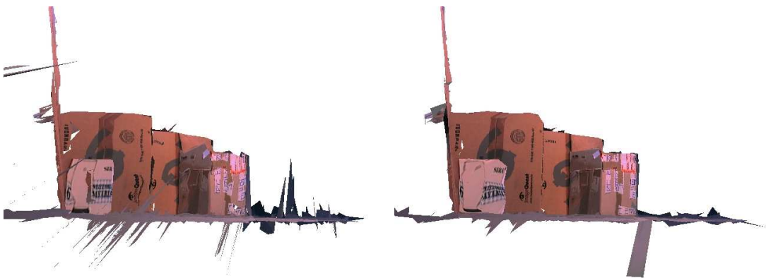
Abbildung 6.6: Resultierende Qualität für schnelle und normale Berechnung. Für die Berechnung des linken Bildes wurde die Tiefenkarte ungefiltert verwendet und die Anzahl der Dreiecke für die Triangulierung deutlich reduziert. Die Ansicht wurde so gewählt, dass die entstehenden Fehler deutlich sichtbar werden.
