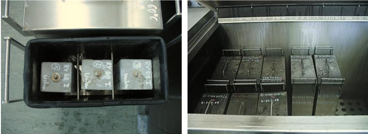
Abbildung 23: Probekörper in Edelstahlbehälter (links), Edelstahlbehälter in Prüfruhe (rechts)
