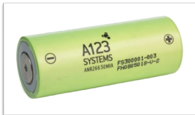
Abbildung 4-2: Für die Messungen verwendete \text{LiFePO}_4 -Zelle ANR26650 der Firma A123 Systems
