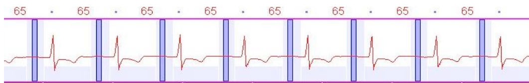
Abb. 11b: EKG-abhängige Röhrenstrommodulation mit schmalem Pulsingfenster (70%) bei einer beispielhaften Herzfrequenz von 65 Schlägen/min.
