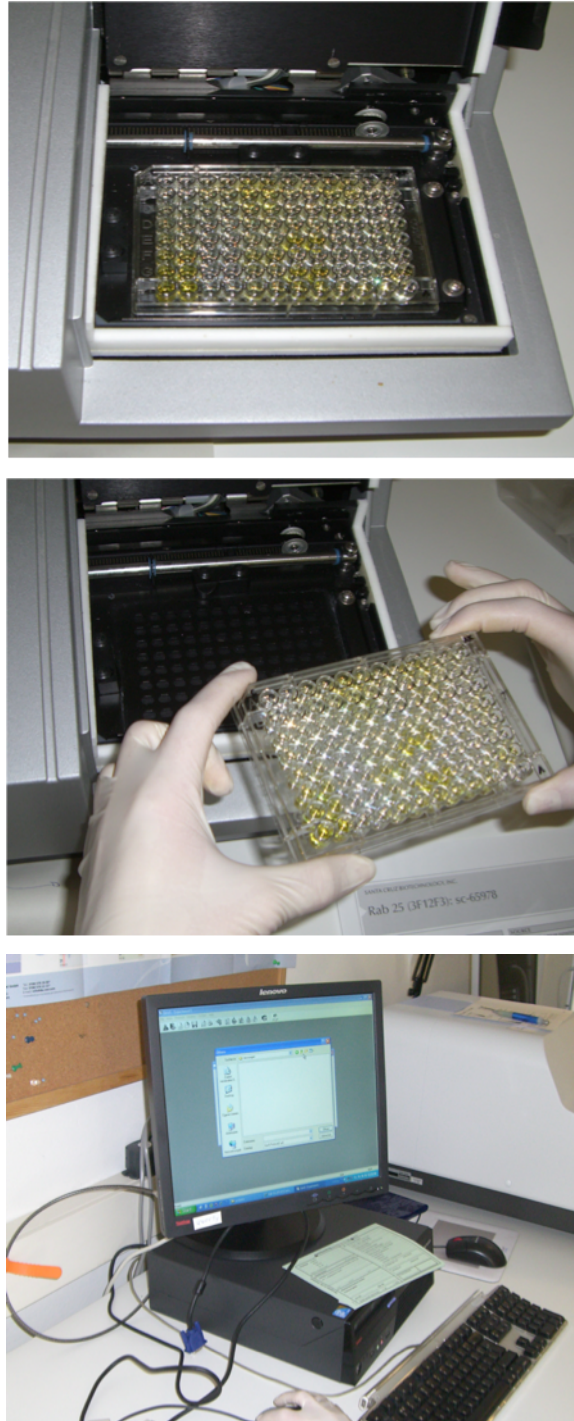
Abbildung 10: ELISAreader (oben, mitte) und dazugehöriger Computer (unten)
