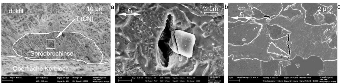
**Abbildung 85:** a) Inselartige Sprödbruchfläche um eine Ti(CN)-Ausscheidung an einer Lochzugprobe, Stahl DP1200, b) Wasserstoffinduzierter Riss in einer Bügelprobe ausgehend von einer Ti(CN)-Ausscheidung,  $\varepsilon_t = 3,9\%$ , Stahl CP1400, c) Wasserstoffriss in einer Bügelprobe, ausgehend von einer ZrN-Ausscheidung,  $\varepsilon_t = 4\%$ , Stahl DP1200.
