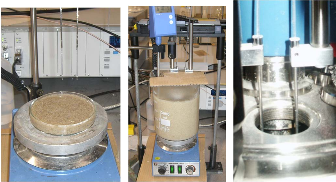
Abbildung 88: Mischversuche in einer Petrischale (links) und in einem Becherglas zur generellen Eignungsprüfung (Mitte), und im Mischreaktor (rechts); alle Abbildungen jeweils mit den PDW-Laserdioden
