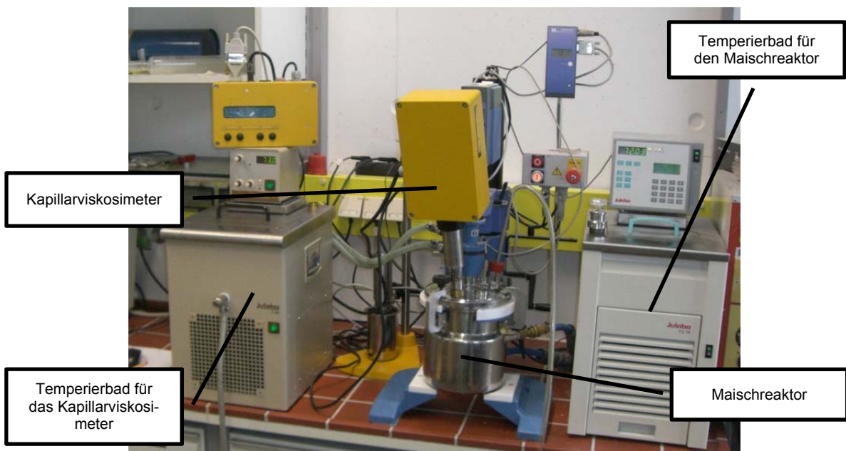
Abbildung 7: Laborreaktor LR 2001, IKA, Staufen, mit eingebauten Geräten
