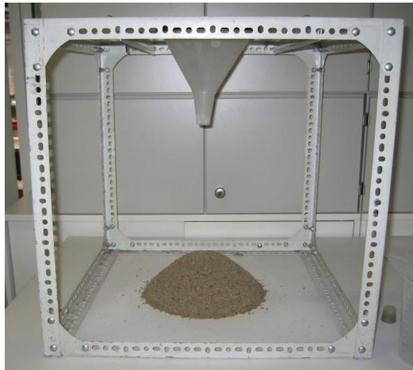
*Abb. 6.5: Versuchsvorrichtung zur Bestimmung des Böschungswinkels nach DIN*
