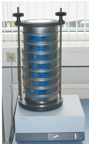
*Abb. 6.6: Gerät für die fraktionierte Korngrößenanalyse (Schwingsieb-Analyse)*
