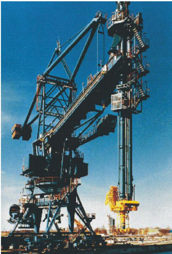
*Abb. 1.3: Schiffsentlader mit Hochleistungs-Schneckenförderer*
