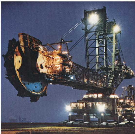
*Abb. 1.1: Schaufelradbagger aus dem Tagebau*
