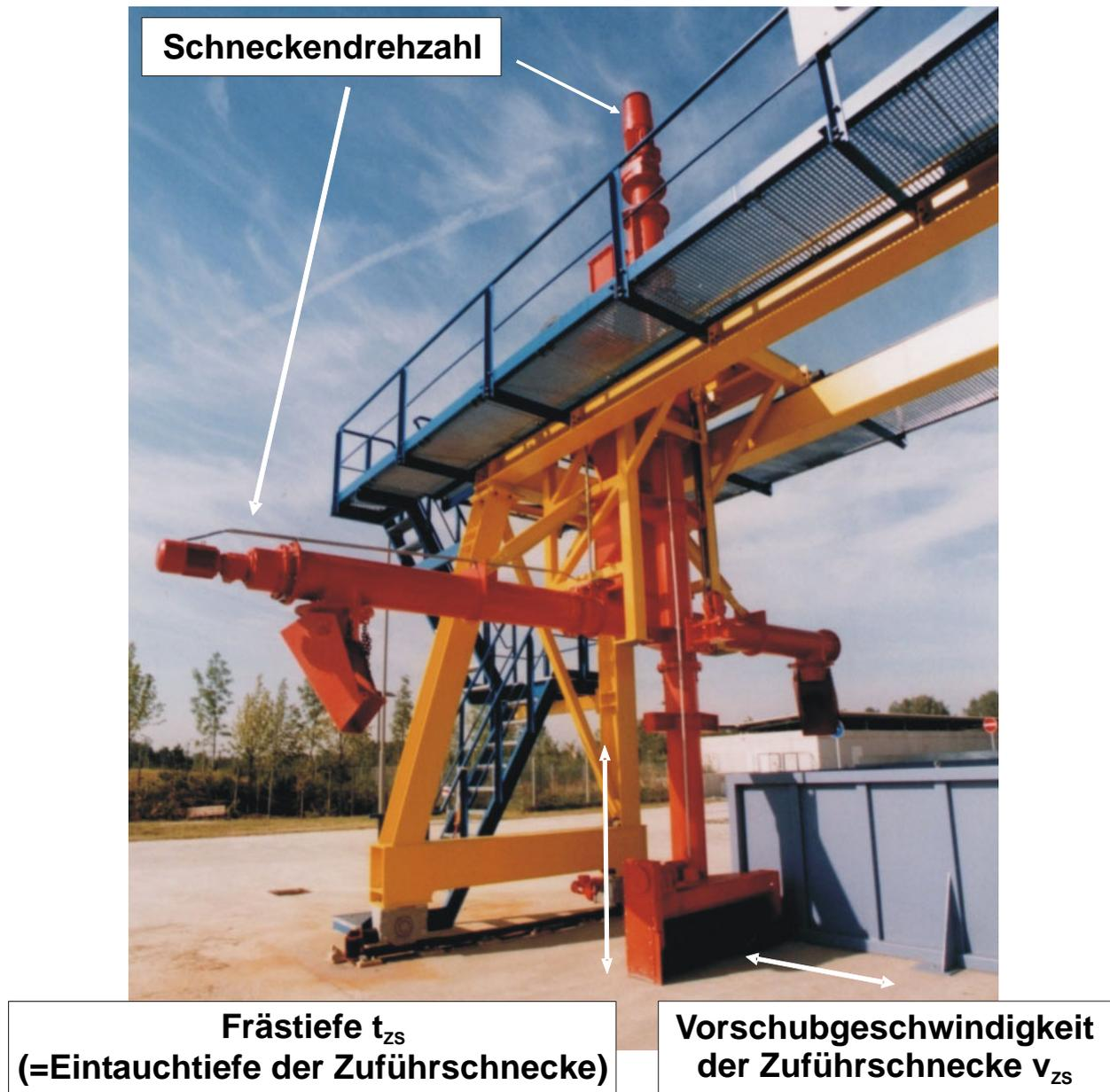
Abb. 6.7: Einstellparameter am Versuchsstand
