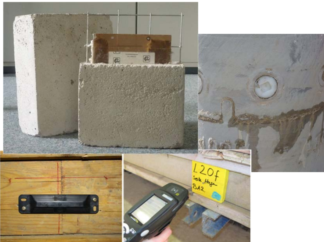
Abbildung 5 RFID Kennzeichnung von Bau-Betriebsmitteln
