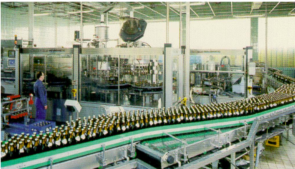
Abbildung 16: Pufferstrecke in einer Abfüllanlage [Krones]
