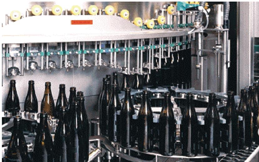
Abbildung 11: Füllmaschine [Krones]
