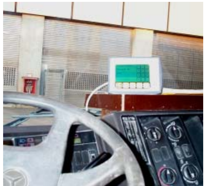
Bild 1: Einbaubeispiel Bordrechner (Foto Max Bögl)
