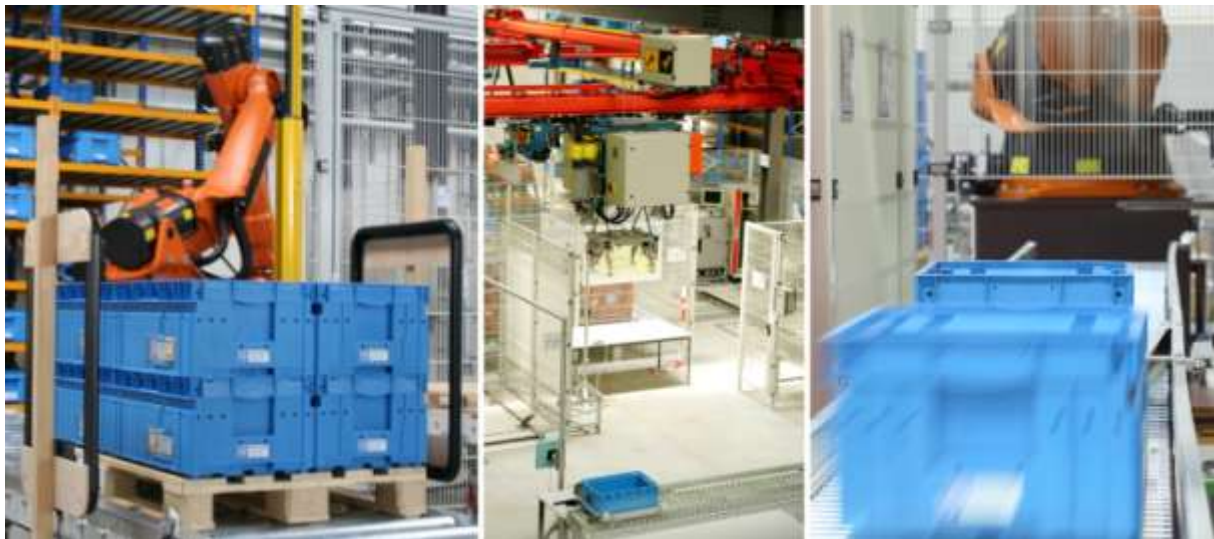
Bild 3 fml-Versuchsanlage: Transporteinheiten steuern (Fördertechnik-)Module
