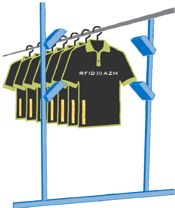
Abbildung 3: Versuchsaufbau zur Identifikation der Reihenfolge einzelner Textilien
