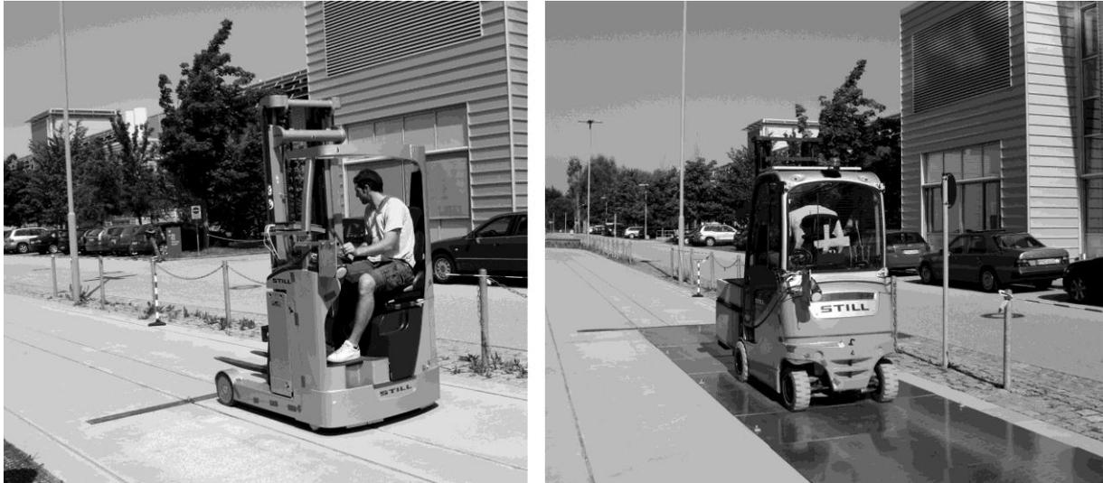
Bild 4: Schwellenüberfahrt und Sprunganregung auf der Teststrecke des Lehrstuhls fml mit einem Schubmast- und einem Gegengewichtsgabelstapler
