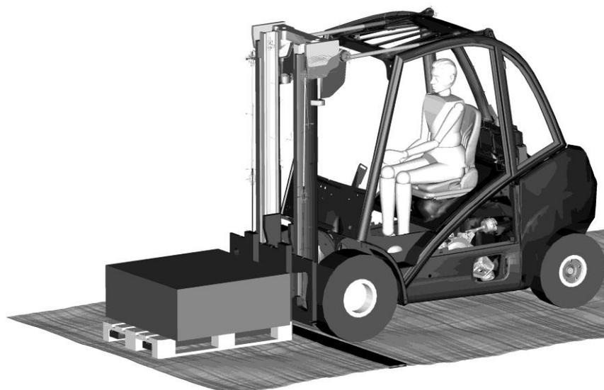
Bild 12: Mehrkörpermodell eines Gegengewichtsgabelstaplers bei Schwellenüberfahrt
