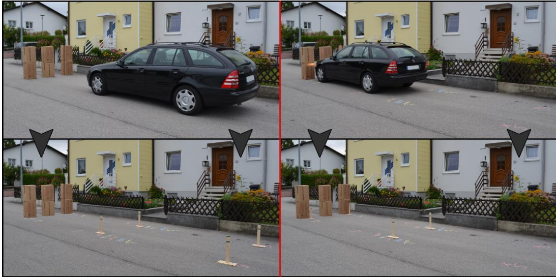
Abbildung 5.1: Aufbau zur Erfassung der Bilder für den Probandentest. Links: Fahrzeug und Eckmarkierungen an der Startposition. Rechts: Fahrzeug und Eckmarkierungen an einer der zu prädizierenden Positionen.
