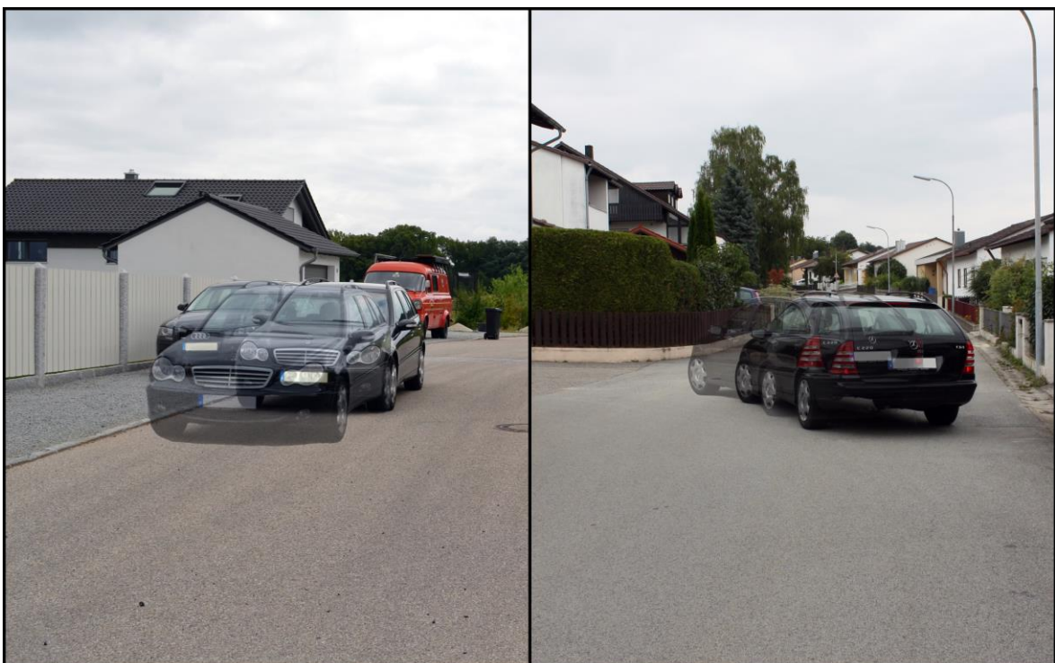
Abbildung 4.5: Darstellung der Fahrzeugprädiktion mittels der Überlagerung eines 3D-Modells mit 50 % Deckkraft
