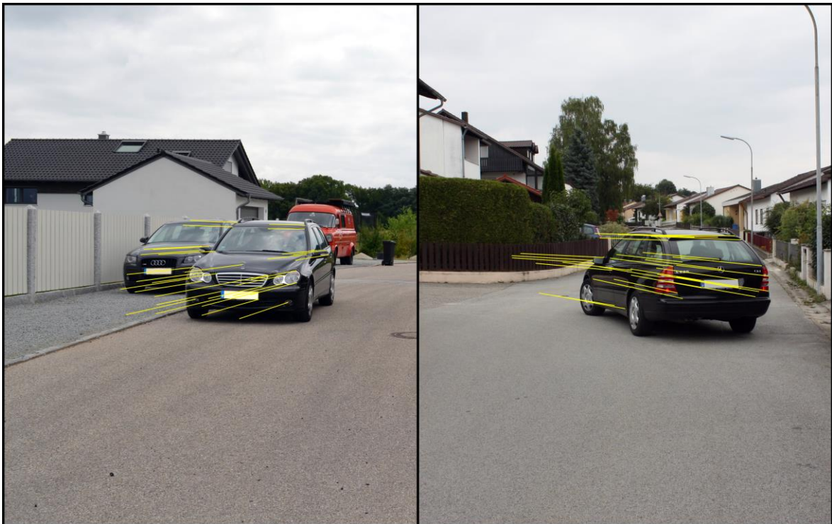
Abbildung 4.9: Position markanter Fahrzeugpunkte als Darstellungsmethode der Fahrzeugprädiktion
