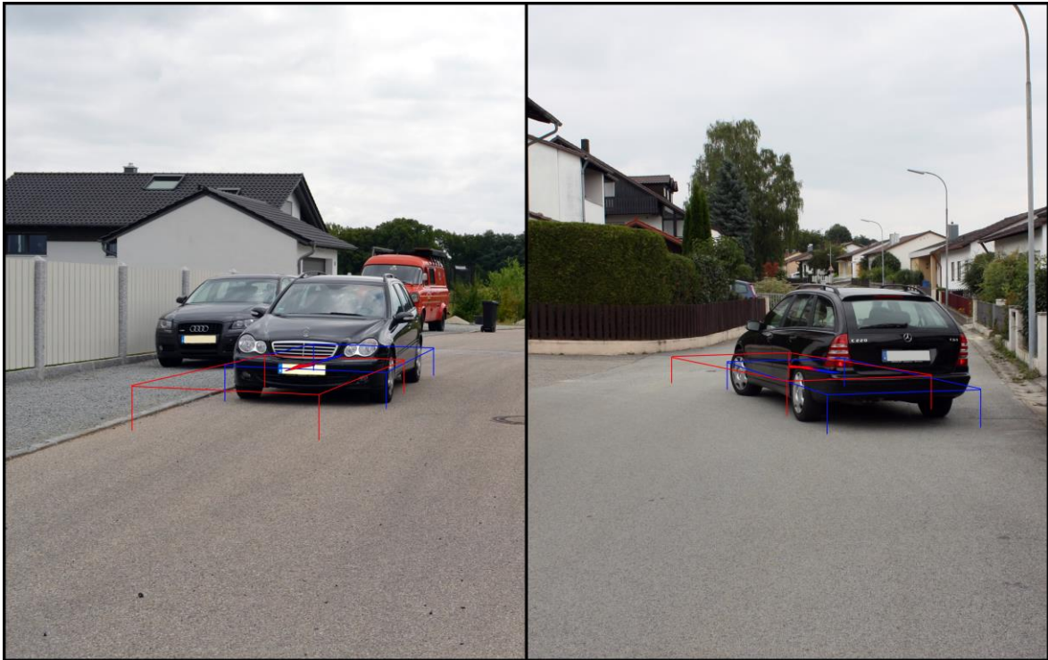
Abbildung 4.11: Rahmen Stoßstange als Darstellungsmethode der Fahrzeugprädiktion
