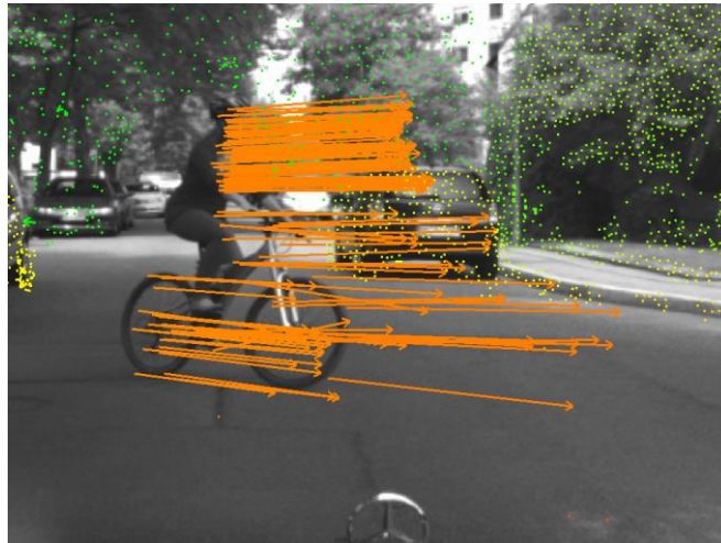
Abbildung 4.3: 6D-Vision Technik von Daimler am Beispiel einer Radfahrerprädiktion [Rab13]
