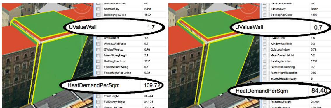
Abbildung 41: Interaktive Veränderung von Gebäudeparametern (z. B. zur Simulation einer Wärmedämmung) und deren Auswirkungen auf den Energiebedarf bzw. die Energieeffizienz
