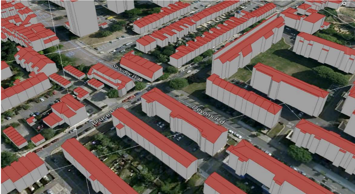
Abbildung 29: Visualisierung eines Ausschnittes des erzeugten semantischen 3D-Stadtmodells der Region Bromley-by-Bow in London, ohne Fassadentexturierung
