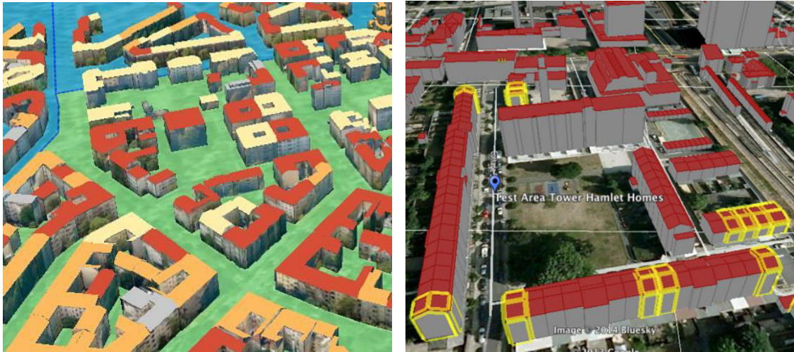
Abbildung 11: Links: Virtuelles 3D-Stadtmodell von Berlin mit texturierten Gebäuden und Dacheinfärbungen bezüglich ihrer Eignungsklasse für Photovoltaikanlagen sowie farbigen Bezirksgrenzen als transparente Bodentextur, Rechts: Virtuelles 3D-Stadtmodell von London im Urzustand mit selektierten (gelb) Gebäuden
