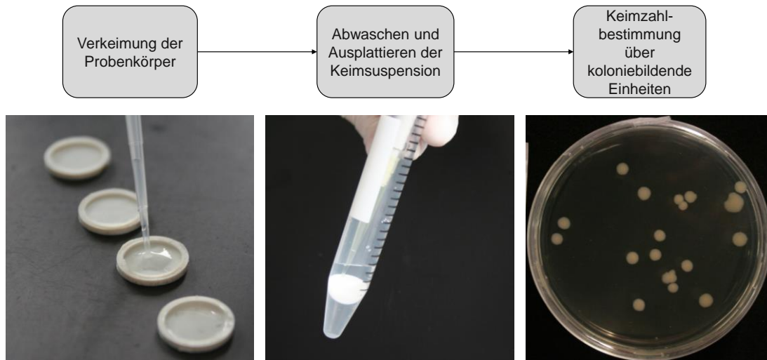
Abb. 25: Untersuchung der keimreduzierenden Wirkung von Kunststoffkompositen. Nach der Verkeimung der Probenplättchen mit der E. coli -Suspension und einer einstündigen Inkubation wird die Keimsuspension abgewaschen und auf Agarnährböden ausplattiert. Die Auswertung der Keimreduktion erfolgt nach 24-stündiger Inkubation der Agarplatten bei 37 °C über das Auszählen der koloniebildenden Einheiten (kBE).
