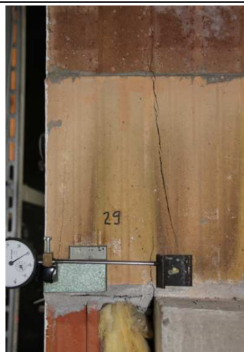
fortschreitende Rissbildung an beiden Stirnseiten der Wände
