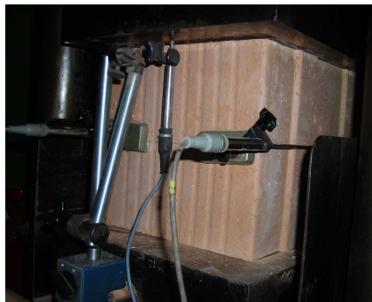
Abbildung 3.1: Druckfestigkeitsprüfung am Einzelstein nach [DIN EN 772-1: 2011]
