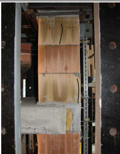
fortschreitende Rissbildung an beiden Stirnseiten der Wände
