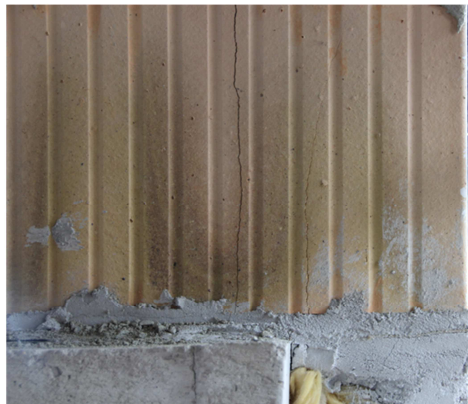
Abbildung 4.42: Rissbildung im Querstegbereich am Wandfuß als Folge lokaler Differenzverformungen im Großversuch (s. a. Kapitel 3.6)
