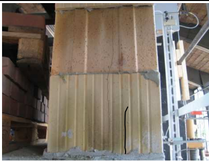
abnehmende Rissbildung / Fugenklaffung im WDK-Bereich
