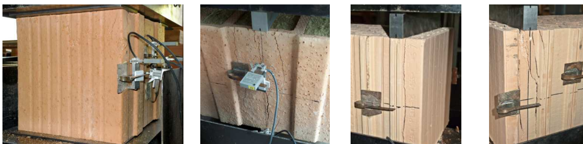
Abbildung 3.2: Teilflächen-Druckfestigkeitsprüfungen am Einzelstein
