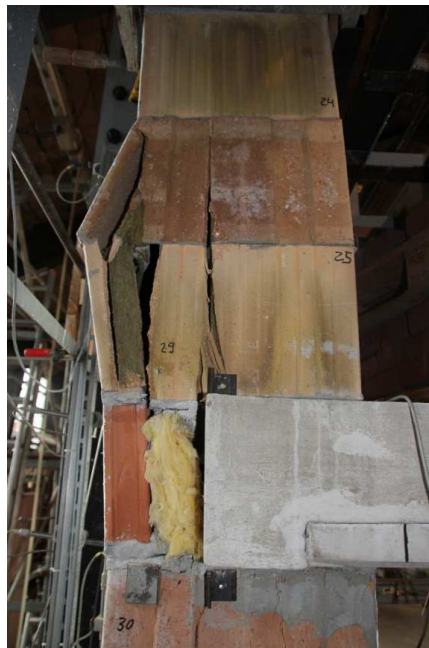
Bruchversagen des Mauerwerks im Wandaußenseitenbereich
