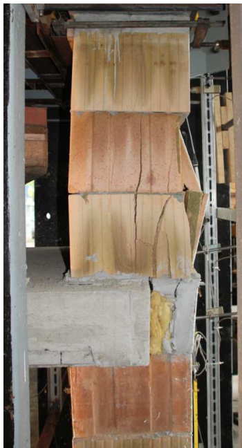
Bruchversagen des Mauerwerks im Wandaußenseitenbereich
