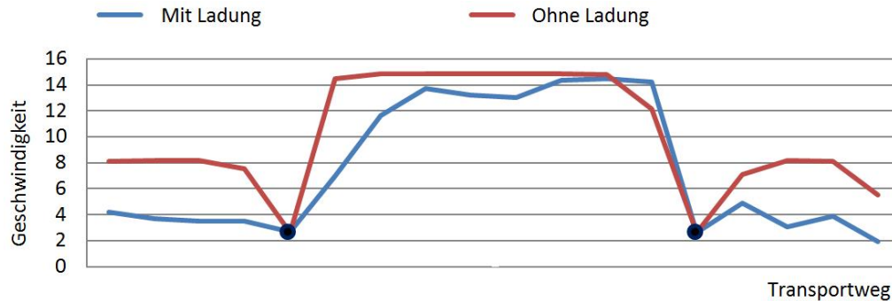
Abbildung 7.2.4: Einfluss der Transportgeschwindigkeit auf den Transportweg um die Brückenbaustelle herum. Das Profil der Transportgeschwindigkeit zeigt, wie schnell die Transportfahrzeuge auf den unterschiedlichen Fahrstrecken entlang der gesamten Erdbaustelle fahren. An den zwei Engstellen (schwarze Punkte) verringern sich die Fahrgeschwindigkeiten der Transportfahrzeuge erheblich.
