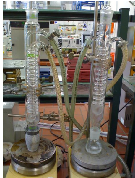
Abb. 6-4: Versuchsaufbau der Isomerisierung im Specksteingefäß; links: Specksteingefäß, rechts: Erlenmeyerkolben (Kontrolle).
