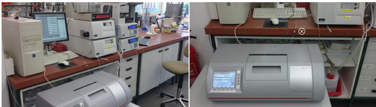
Abb. 6-5: Links: HPLC-Anlage 1 mit Polarimeter als zusätzlichen Detektor; rechts: Nahaufnahme des Polarimeters MCP 500 (Firma Anton Paar), verbunden mit dem Ausgang des UV-Detektors (⊗).
