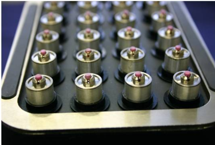
Abb. 4. Scherwellen-Ultraschallarray mit federnd gelagerten Punktkontaktprüfköpfen.
