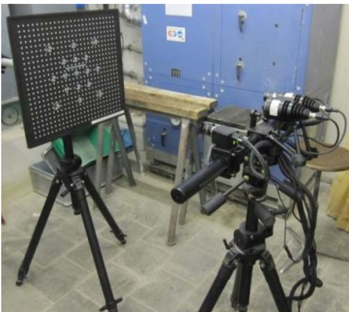
**Abbildung 2-18: Aramis 5M Kamerasystem vor Kalibrierplatte.**
