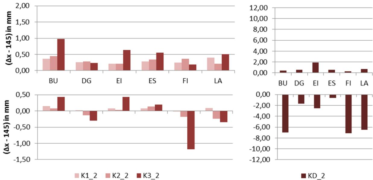
Abbildung 12-6: Abstandsänderung  $\Delta x$  zum Referenzabstand 145,0 mm. Maximalwerte während, oben, und Minimalwerte nach 24 h Trocknung, unten. Prüfkörper der Klimafolgen K1, K2 und K3, links, sowie KD, rechts, bestehend aus zwei Lamellen.
