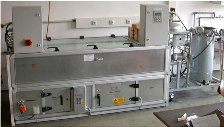
**Abbildung 3-3: Delaminierungsanlage „ULWA-E“, Ulrich Lübbert Warenhandel GmbH & Co.KG, mit Trocknungskammer, links, und Druckkessel, rechts.**
