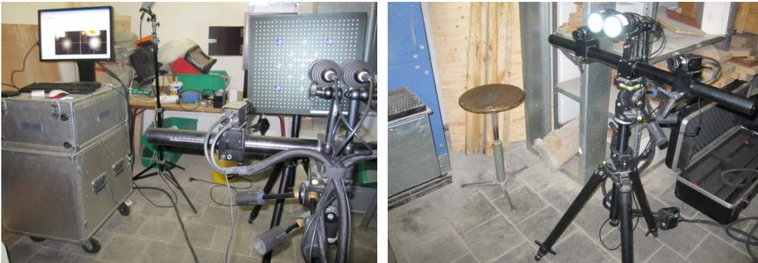
**Abbildung 3-23: Optisches Messsystem Aramis 5M.**
