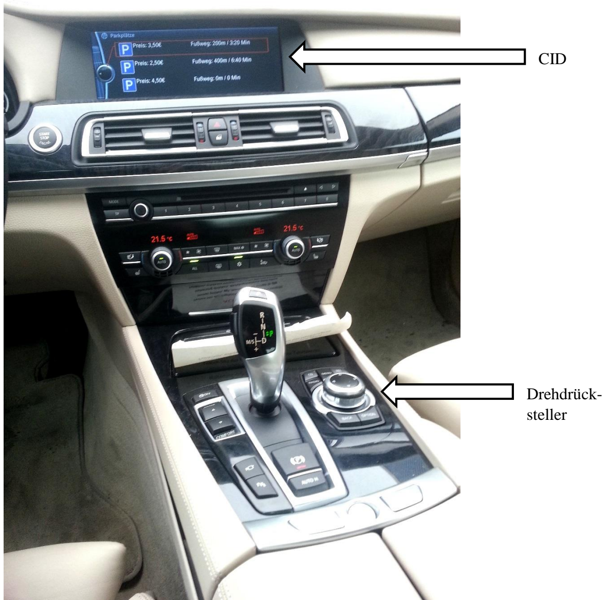
Abbildung 5-6: Foto des Fahrzeuginnenraums inkl. Anzeige- und Bedienkonzept für den Feldversuch (Quelle: Kohl (2013))
