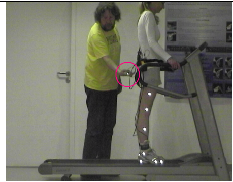
Abb.31 Synchronisationsvorgang von Marker-Tracking-Videoanalyse mit Pedobarometrie: manuelle Abgabe eines LED-Lichtblitzes
