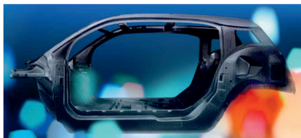
Abbildung 1.1: Fahrgastzelle des BMW i3 aus Faserverbundwerkstoff [52]
