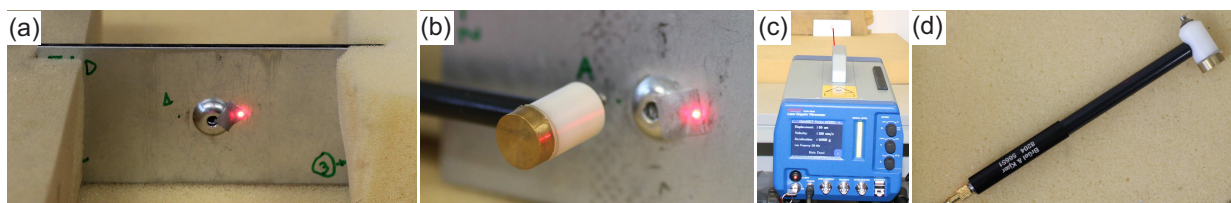
Abbildung 3.13: Prüfung einer Stahl-FVW-Mischbauverbindung mit einem Laser-Doppler-Vibrometer bei Schwingungsanregung mit einem Impulshammer
