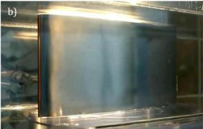
Abbildung 3.16 **a)** Rein thermoelektrisches Referenzsystem (Heizmatte) im Bereich der Flügelvorderkante des *NACA* 0012 Flügelprofils aus Polyamid und **b)** Installation des Referenzsystems in der Testsektion des Vereisungswindkanals nach Applikation einer 0,1 mm Stahlfolie auf der Flügeloberfläche.
