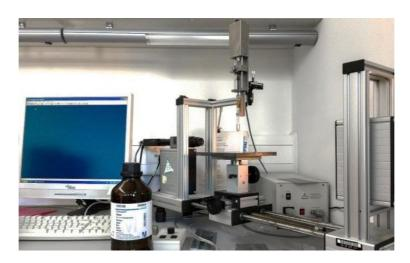
Abbildung 3.3 Messstand von Krüss zur Bestimmung des Kontaktwinkels zwischen einer Festkörperoberfläche und einer Flüssigkeit (Wasser) [170].
