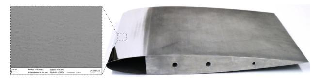
Abbildung 3.10 *NACA* 0012 Flügelprofil mit spiegelpolierter Aluminiumoberfläche im Bereich der Vorderkante und Detailaufnahme einer zu dem Flügelprofil identisch spiegelpolierten ebenen Probenoberfläche mit dem *REM*.
