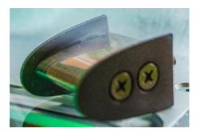
Abbildung 3.8 Glatte Aluminiumoberfläche des Probenkörpers mit  $R_a=110\pm 8~nm$  [114] sowie seitlich am Probenkörper befestigte Trennscheiben aus *PVC*.
