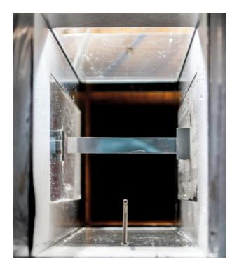
Abbildung 3.21 Darstellung eines innerhalb der Testsektion des Vereisungswindkanals positionierten Probenkörpers. Der Blick auf den Probenkörper erfolgt in Richtung der Strömung. Die Prandtl-Sonde zur Messung der Strömungsgeschwindigkeit und Totaltemperatur während des Vereisungsvorgangs ist unten dargestellt [170].
