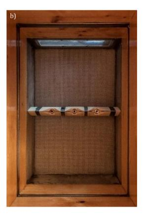
Abbildung 3.1 **a)** Übersichtsdarstellung des Vereisungswindkanals auf Labormaßstab, bestehend aus den Hauptkomponenten Ventilator (1), Wärmetauscher (2), Beruhigungskammer (3) mit Sprühsystem, Beschleunigungsdüse (4) und Testsektion (5) und **b)** Darstellung der drei in einem *NACA* 0030 Flügelprofil integrierten Zweistoffdüsen.
