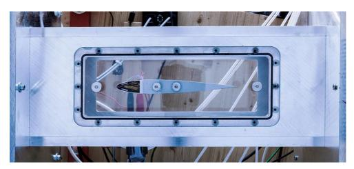
Abbildung 7.2 In der Testsektion des Windkanals bei einer 0  $^{\circ}$  Anstellwinkelkonfiguration eingebautes *NACA* 0012 Flügelprofil mit dem im Bereich der Vorderkante integrierten hybriden Systemansatz.
