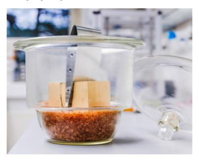
Abbildung 3.12 Hydrophobierung des *NACA* 0012 Flügelprofils in einem Exsikkator zur Herstellung der eisphoben Eigenschaften der glatten, nanostrukturierten Oberfläche im Bereich der Flügelvorderkante.
