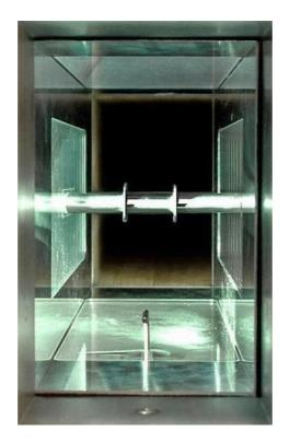
Abbildung 3.17 Darstellung des innerhalb der Testsektion des Vereisungswindkanals positionierten Flügelprofils mit dem im Bereich der Flügelvorderkante eingebauten Probenkörper vor Beginn des Vereisungsvorgangs. Der Blick erfolgt auf die Vorderkante des Flügelprofils in Richtung der Strömung. Die Prandtl-Sonde zur Messung der Strömungsgeschwindigkeit und Totaltemperatur während des Vereisungsvorgangs ist unten dargestellt [114].
