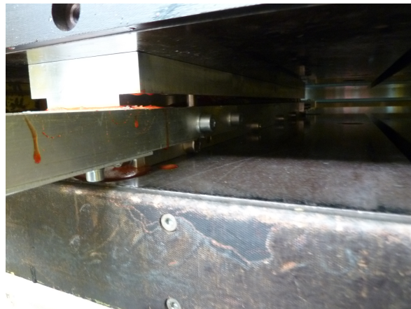
Abbildung 4.20.: Die Herstellungsform für die Balkenteststruktur befindet sich in der hydraulischen beheizten Presse bei AHD.
