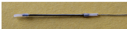
(c) Gekapselter Temperatursensor. Zu sehen ist der Draht des Thermoelements, die optische Glasfaser ist aufgrund der Abmessungen nicht zu erkennen.
