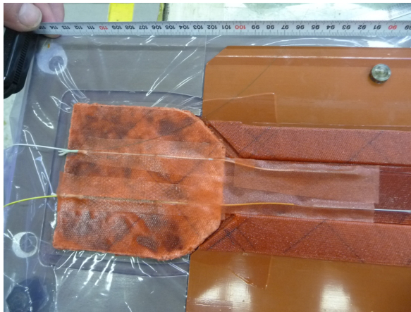
Abbildung 4.42.: Draufsicht auf die Torsionsfasern. Rechts im Bild sieht man die Spleißschutzhülsen, welche sich nach der Aushärtung als Bruchstelle erwiesen.
