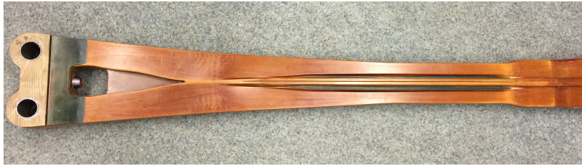
Abbildung 4.29.: Flexbeamstruktur im Rohzustand. Links im Bild sind die Löcher für den Anschluss am Rotorkopf zu sehen.
