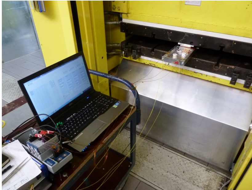
Abbildung 5.5.: Experiment zur Temperaturmessung mit FBG-Sensoren. Der Versuch wurde in der Rotorblattproduktion bei AHD durchgeführt.
