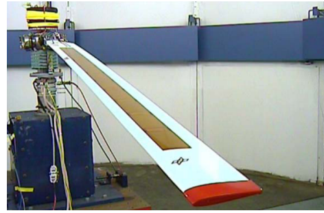
(b) Active Twist Blatt des Deutschen Zentrum für Luft- und Raumfahrt (DLR) [60]
