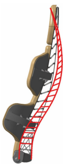
(a) Bionik-Sitz (In Ausgangssituation (schwarz) und bei einer Drucksituation (rot))
