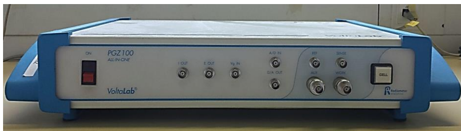
Abbildung 3-7: Potentiostat PGZ 402, Firma Volta Lab Instruments. Der resultierende Stromdichteverlauf ist graphisch durch Volta Master 4 (Version 7.8.26338.3) aufgezeichnet worden (entnommen aus [9]).
