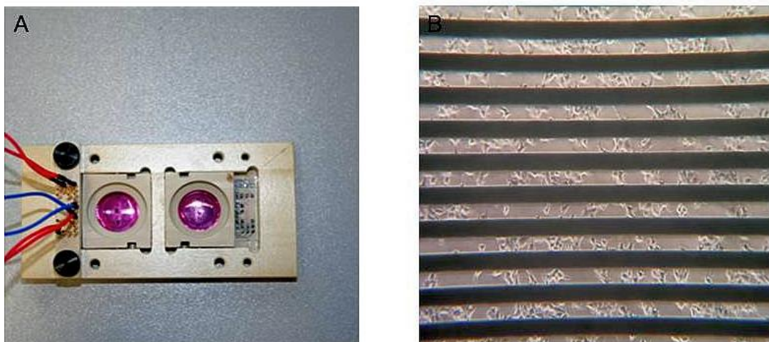
Abbildung 3-6: Vorrichtung zur chronoamperometrischen Messung. Doppelwellkammer mit angeschlossenen Kontaktstecker: Die Wells sind mit DMEM + 5% FCS gefüllt (A); MCF-7 Zellen zwischen IDEs Strukturen auf Glas-Sensorchip (B). Die elektrochemische Zelle baute man in den Versuchen mit 3 Elektroden auf: einer Messelektrode, einer Gegenelektrode und einer Referenzelektrode. Als Mess- und Gegenelektrode wurden Platin-Elektroden verwendet (IDES). Die Glas-Sensorchips wurden in einer Doppelwellkammer aus PEEK installiert und mittels eines Federkontaktsteckers kontaktiert. Über die Federkontaktstifte legte man die Spannung an.
