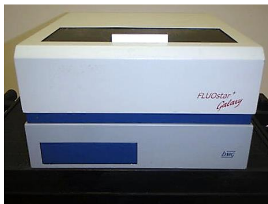
Abbildung 3-3: FLUOstar Galaxy, ein Fluoreszenz Microplate Reader zur Messung der Fluoreszenz-Intensität (z. B. im Resazurin-Assay), Firma BMG LABTECH (entnommen aus [35]).
