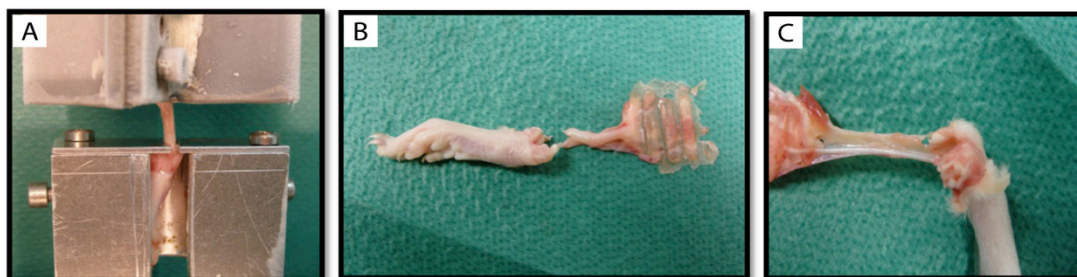
A: „Cryo-Clamp“ mit Stickstoff gefüllt (oben), Schlitzplatte als Widerlager (unten) B, C: Sehnenregenerat nach Testung
