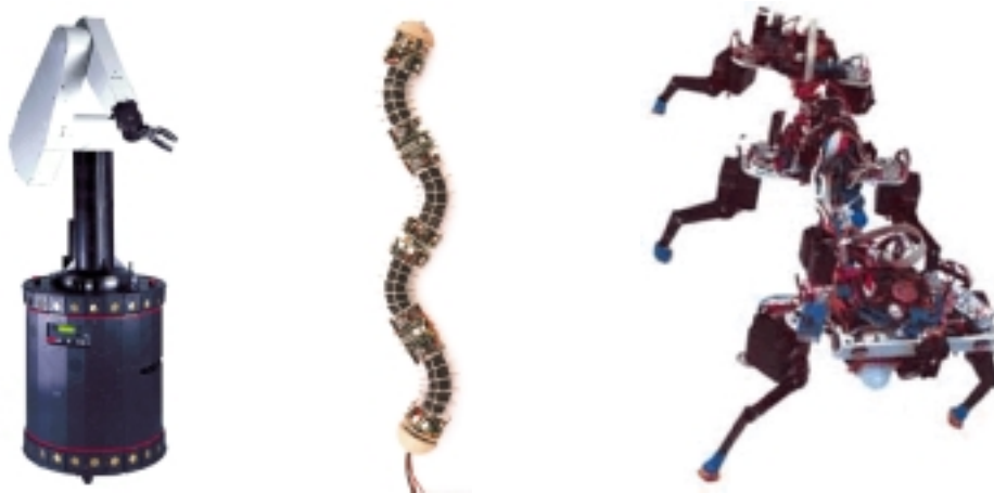
Abbildung 3: Beispiele für Serviceroboter. Links: Universalroboter der Firma Nomad Technologies mit multi-sensorgestützter fahrbarer Plattform und aufgesetztem Puma-Arm der Firma Unimation. Mitte: Prototyp einer hochbeweglichen „Schlange“ der GMD mit der Fähigkeit, in Kanälröhren zu navigieren. Rechts: Beispiel für einen „insektoiden Roboter“ zur Navigation in unwegsamem Gelände (z.B. zur Minensuche).
