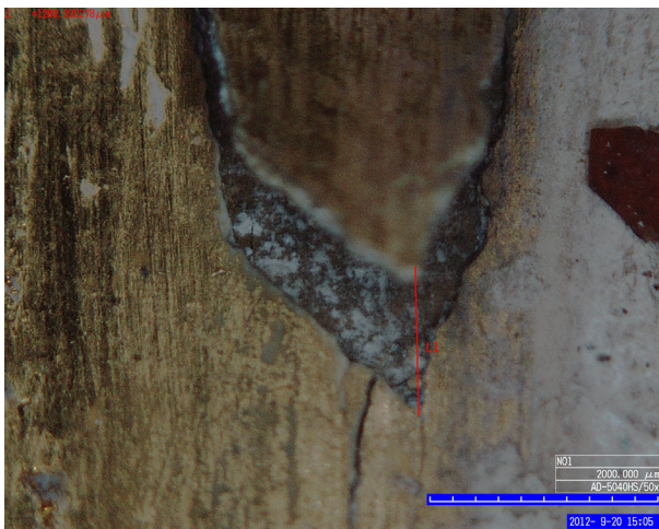
Abbildung 4.35: Vergleichende Aufnahme mit dem 3D-Mikroskop. Links: Aufstehende Fassungsscholle am 20.09.2012, 14:00 Uhr bei 14 °C, 65 % rF. Rechts: Selber Ausschnitt am 21.09.2012, 09:00 Uhr bei 11,5 °C, 73,8 % rF. Von der Spitze der abstehenden Scholle bis zur angrenzenden Schicht wurde eine insgesamt Längenänderung von 11 µm gemessen (L1 links =1290 µm; L1 rechts =1301 µm).
