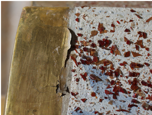
Abbildung 4.34: Links: Lockerung der Vergoldung vor der Festigung, rechts: Selbe Position einige Monate nach der Festigung. In den unteren Ausbrüchen ist die Festigung noch erfolgreich, die obere Scholle steht erneut auf.
