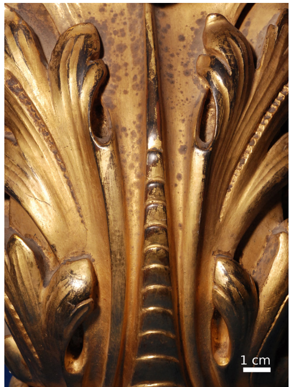
Abbildung 4.12: Schimmelbildung auf dem Überzug (Leim?) an vergoldeten Pfosten des Paradebetts.
