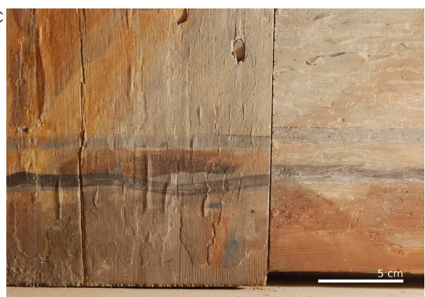
Abbildung 4.41: Detail des farbig gefassten Holzrahmens am Seitenaltar des Hl. Franziskus. Die Farbschicht ist gelockert und bildet Blasen.
