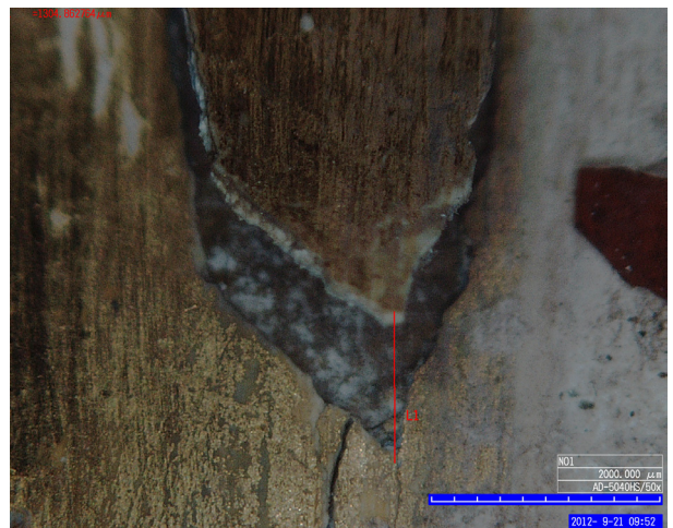
Abbildung 4.35: Vergleichende Aufnahme mit dem 3D-Mikroskop. Links: Aufstehende Fassungsscholle am 20.09.2012, 14:00 Uhr bei 14 °C, 65 % rF. Rechts: Selber Ausschnitt am 21.09.2012, 09:00 Uhr bei 11,5 °C, 73,8 % rF. Von der Spitze der abstehenden Scholle bis zur angrenzenden Schicht wurde eine insgesamt Längenänderung von 11 µm gemessen (L1 links =1290 µm; L1 rechts =1301 µm).
