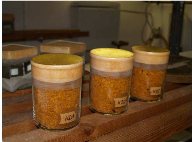
Abbildung 5.2: Dry-cup-Messung an polimentvergoldeten PE-Fritten in den Prüfkammern des Fraunhofer-Instituts für Bauphysik.
