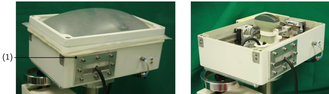
Abbildung 4.2: Manipulator: *Links*: mit geschlossenem Deckel in betriebsbereitem Zustand. Bei (1) ist der Einlass der US-Sonde zu erkennen. *Rechts*: Isometrische Ansicht des Manipulators bei geöffnetem Deckel.
