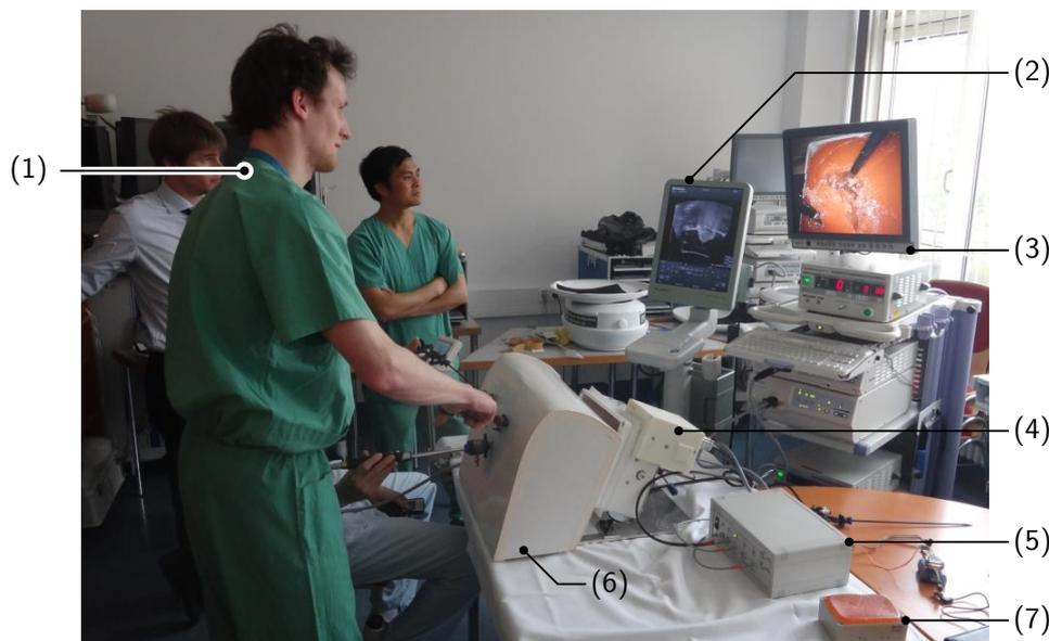
Abbildung 5.8: Versuchsaufbau beim Validierungsexperiment am Universitätsklinikum Leipzig. (1) Am Versuch teilnehmender Operateur; (2) US-Scanner des Sonic-CT; (3) Videolaparoskopieturm; (4) Sonic-CT; (5) Verteilerstation; (6) Torsophantom des Laparoskopie-Trainers; (7) Wechselphantom.
