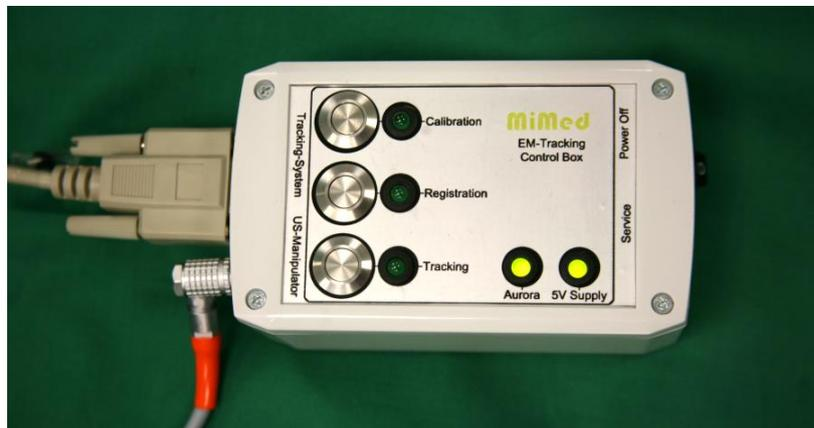
Abbildung 4.12: pControl-EM-Controlbox: Links die Taster zum Aktivieren der Zustände Kalibrieren, Registrieren und Tracking. Rechts unten die Status LEDs für die Verbindung zum NDI Aurora Trackingsystem und die Energieversorgung.
