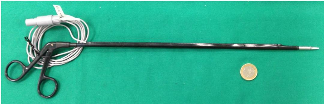
Abbildung 4.11: Laparoskopisches Instrument mit EM-Sensor. Der Sensor ist über eine biokompatible Schrumpfschlauch am Instrument fixiert.
