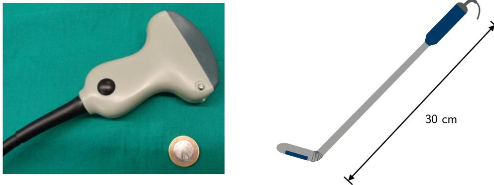
Abbildung 2.7: Ultraschallsonden: *Links*: transkutane US-Sonde, *Rechts*: laparoskopische US-Sonde mit abwinkelbarem Schallkopf.
