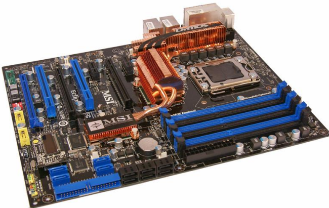
Abbildung 2-13: PC-Motherboard. Beispiel für eine Produktplattform (NADLER 2012)
