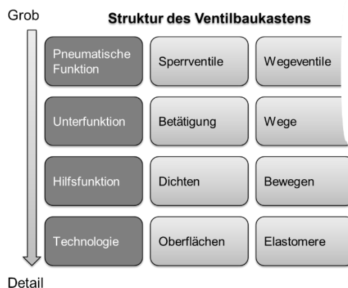
Abbildung 5-26: Ausschnitt aus der Struktur und der Inhalte des Ventilbaukastens
