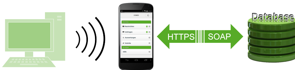
Abb. 6.1.: Schematische Darstellung des Tests zur Überprüfung der Bluetooth-Kommunikation mit verschiedenen mobilen Endgeräten und Android-Versionen
