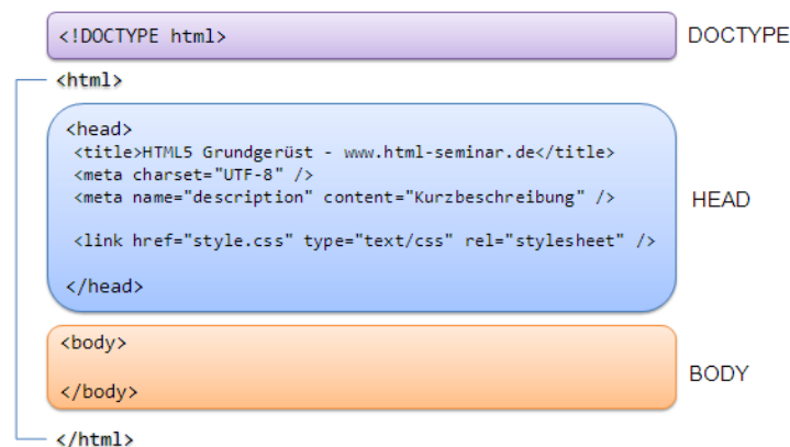
Abb. 5.15.: Grundaufbau eines HTML-Quellcodes [128]
