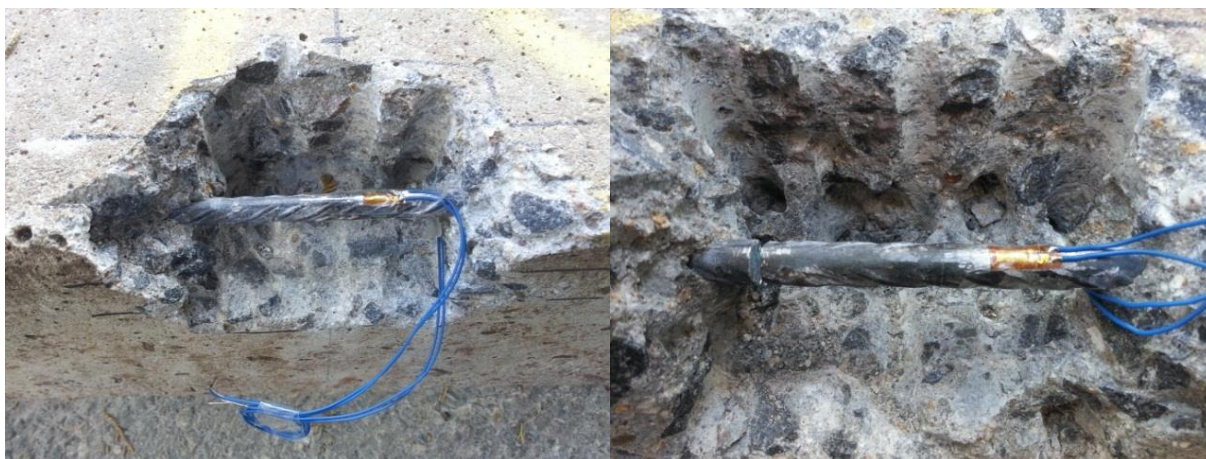
Abbildung 34: Spannstahl mit Dehnmessstreifen vor und nach Durchtrennen
