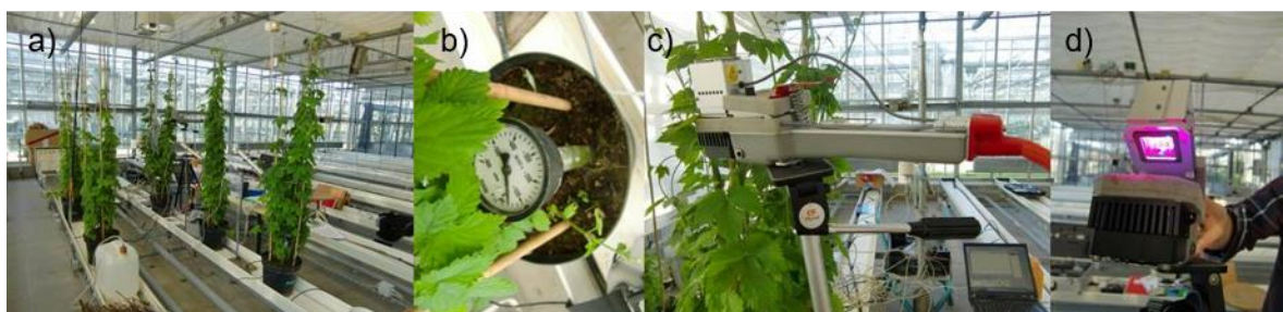
Abbildung 20: Voruntersuchungen im Gewächshaus mittels Lichtkurven. Im Gewächshaus wurden mittels der Gaswechselanlage LC proSD der Firma ADC BioScientific Inc. an sechs Jungpflanzen die Reaktionen auf Trockenstress erfasst (a). Hierzu wurde über mehrere Tage an der Hälfte der Pflanzen Trockenstress durch ausbleibende Bewässerung induziert. Die Auswirkungen wurden sowohl mit Tensiometern (b) als auch mit der Gaswechselanlage aufgezeichnet. Dazu wurden die Blätter in die Küvette (c) eingespannt und unter der Gabe von künstlichem Licht (d) sowohl die Transpirations- als auch die Nettophotosyntheseleistung gemessen.
