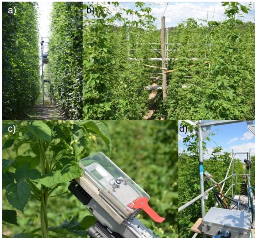
Abbildung 22: Messung der Transpiration und Nettphotosynthese verschiedener Höhenstufen unter natürlichen Lichtbedingungen. Zur Durchführung wurden im Hopfengarten zwei Baugerüste errichtet, um an der gesamten Pflanze messen zu können (a, b und d). Dazu wurden die Pflanzen in die drei Bereiche „unten“, „Mitte“ und „oben“ untergliedert, die jeweils charakterisiert wurden. Zur Messung wurden randomisiert Blätter ausgewählt, an denen die Menge des aufgenommenen Kohlenstoffdioxids und des abgegebenen Wassers in einer Küvette mittels einer sogenannten Gaswechselanlage analysiert werden. Nach dem Einspannen eines Blattes (c) wurde ca. 3 Minuten gewartet, bis sich ein stabiler Wert eingestellt hat, der dann mittels Knopfdruck geloggt wurde. Des Weiteren zeichnet die Anlage die auftreffende Strahlungsmenge (Photosynthetic Active Radiation (PAR) in \mu\text{mol Photonen m}^{-2}\text{s}^{-1} ) auf.
