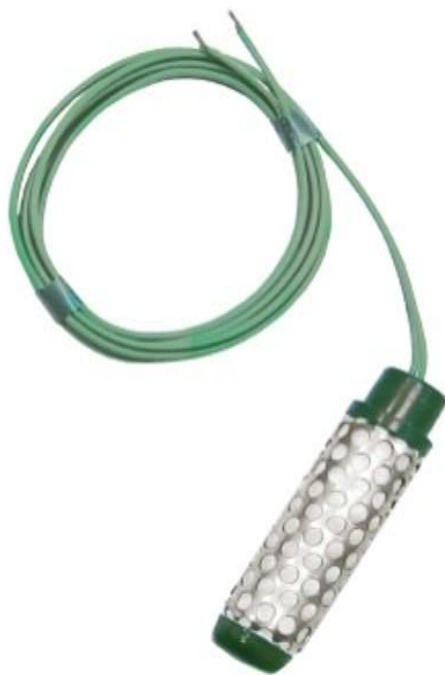
Abbildung 14: Watermarkensensor zur Messung der Saugspannung. Messbereich 0 bis 2000 hPa. Bildquelle: Irrometer Comp., www.irrometer.com ; Stand 27.10.15
