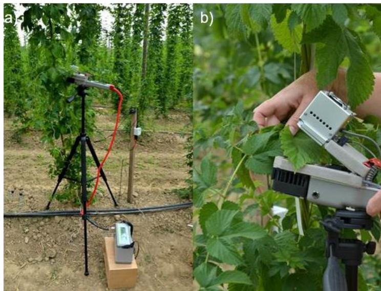
Abbildung 21: Gaswechsellmessungen zum Vergleich der potentiellen Transpirations- und Nettophotosyntheseleistung im Feld. Hierbei wurden im Wechsel insgesamt jeweils neun Blätter von bewässertem und unbewässertem Hopfen der Sorte Herkules bei einer künstlichen Lichtstärke von 1250 \mu\text{mol Photonen m}^{-2} \text{s}^{-1} gemessen. Nach jeweils drei Blättern wurde dabei zwischen den Varianten gewechselt, um einen Effekt der jeweiligen Tageszeit auszuschließen. Die Messungen fanden immer zur Mittagszeit (ca. 11:00 - 14:00 Uhr) statt.
