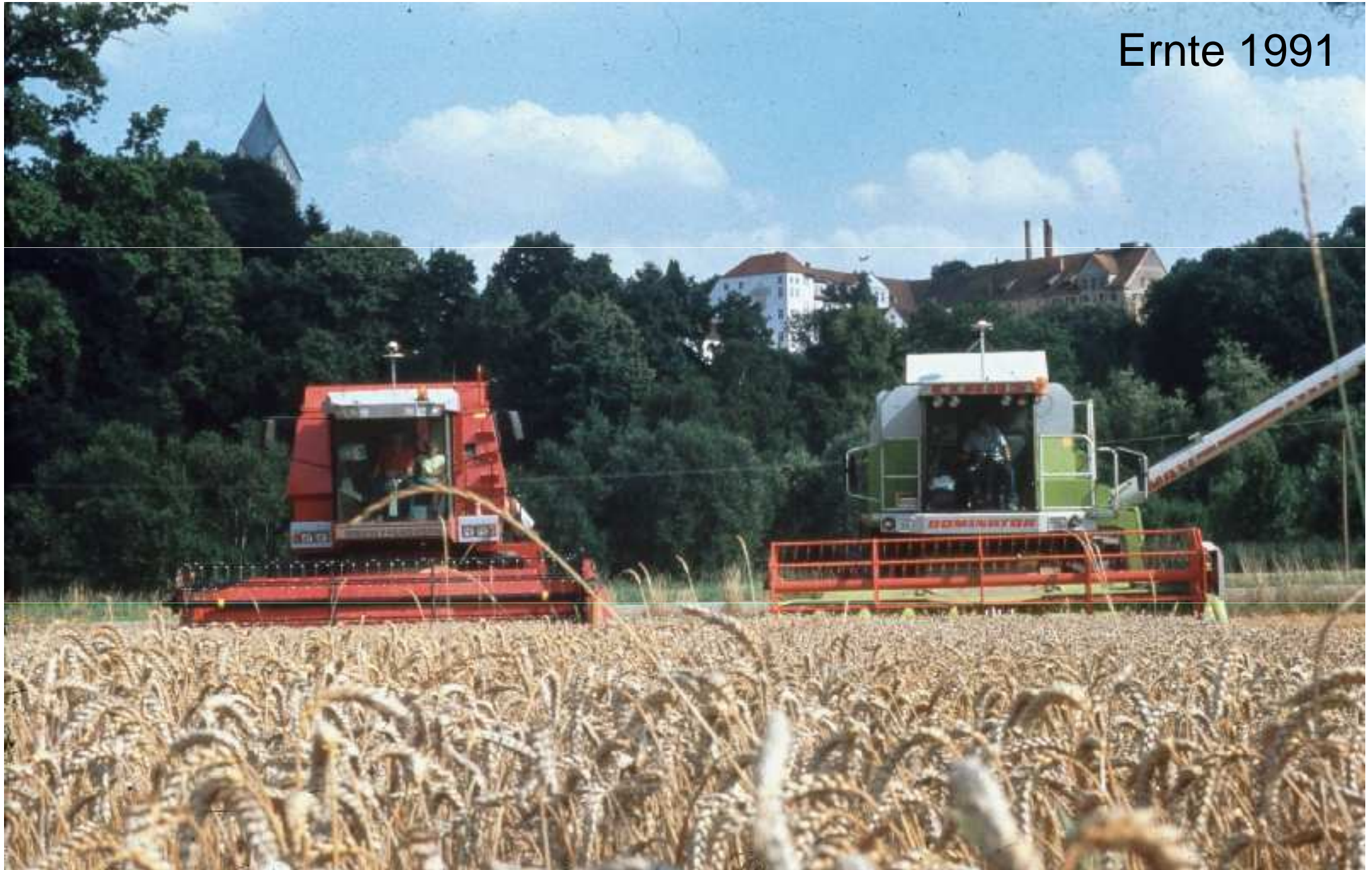
Erster Serienmähdrescher mit GPS und Ertragsermittlung 1990 in Scheyern eingesetzt und getestet!
