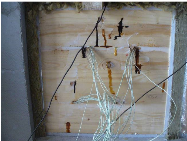
Abbildung A. 8: Austritt von Flüssigkeit (Harz-Wasser Gemisch PK 0% und Wasser PK 6%) auf der Rückseite der Prüfkörper innerhalb der Untersuchungen zum Holzfeuchteeinfluss auf das Abbrandverhalten, 108. Prüfminute
