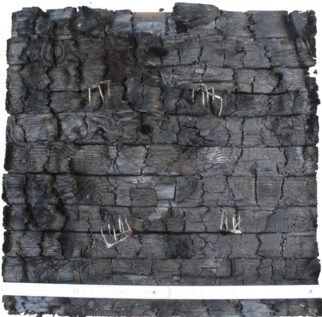
Abbildung A. 13: Darstellung der Restquerschnitte aus Versuch V3 und V8 in der Versuchsserie mit unterschiedlichen Brandszenarien, (Abkühlphase mittel)
