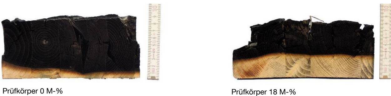
Abbildung 5.4: Restquerschnitte nach 120 Minuten Brandbeanspruchung, Messmarke C; (quer zur Faserrichtung)
