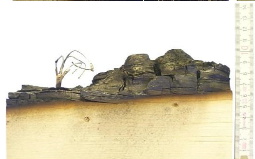
Abbildung A. 13: Darstellung der Restquerschnitte aus Versuch V3 und V8 in der Versuchsserie mit unterschiedlichen Brandszenarien, (Abkühlphase mittel)
