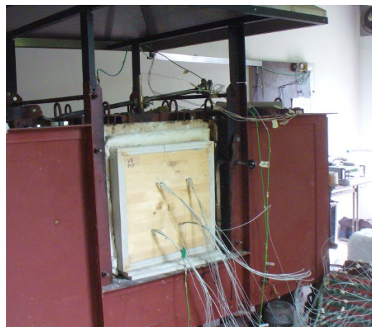
Abbildung 5.9: Aufbau des Versuchsstandes mit dem Prüfkörper (PK) im eingebauten Zustand
