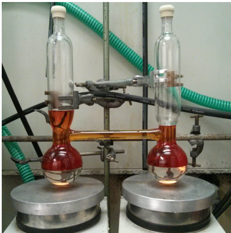
Abbildung 42: Messaufbau nach Haberfeld, mit einer Toluol-Photosäure-Phase (oben) und zwei klaren, wässrigen Phasen (unten).
