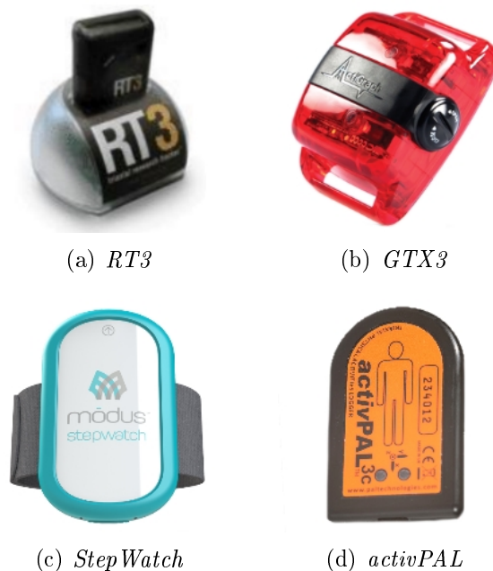
Abb. 2.9: Abbildungen der in Tabelle 2.5 aufgeführten Accelerometer-Systeme: RT3 (Bionetics), GTX3 (ActiGraph), StepWatch (Modus Health) und activePAL (PAL Technologies).
