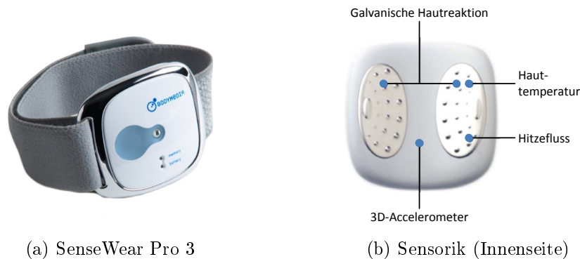
Abb. 2.12: Abbildungen des am Oberarm getragene Multi-Sensor-Systems SenseWear von BodyMedia und die darin verbaute Sensorik (Galvanische Hautreaktion, Hauttemperatur, Hitzeffluss, 3D-Accelerometrie)
