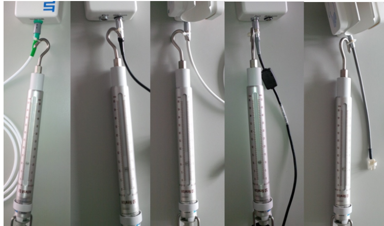
Abbildung 11.10: Prüfen der Steckverbindungen auf unfreiwilliges Lösen mit einer Belastung von 10N
