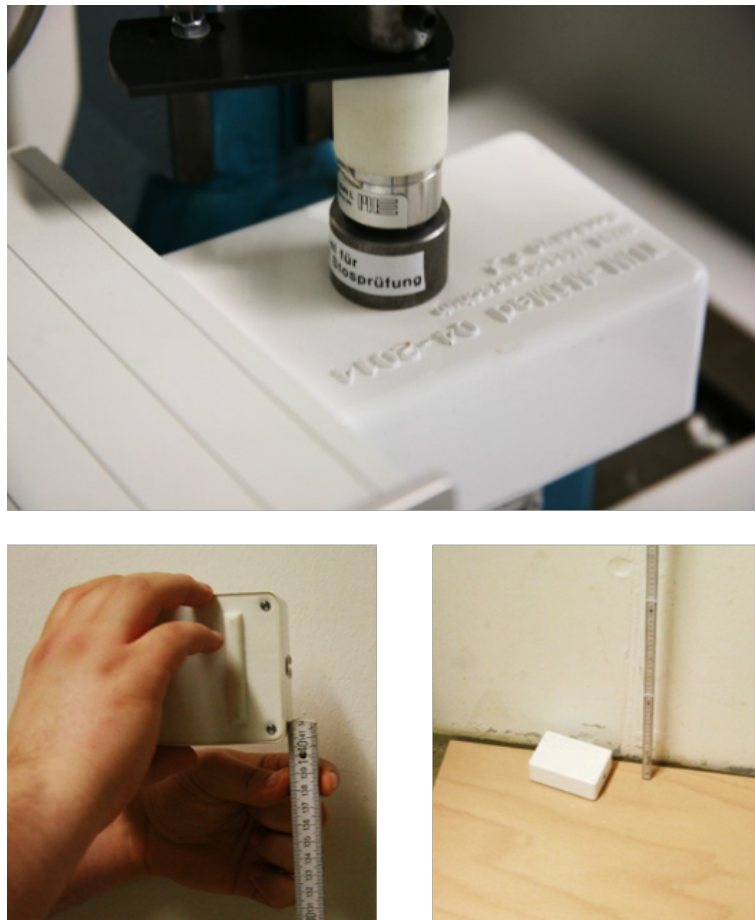
Abbildung 11.12: Mechanische Tests (oben: Stoßprüfung mit einem 30mm Druckstempel; unten: Fallprüfung)
