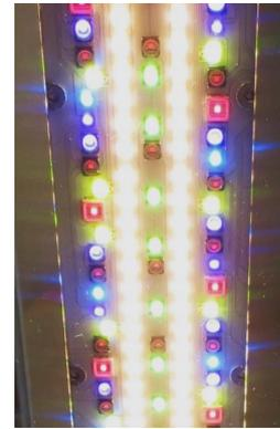
**Abbildung A.9:** Fotografische Darstellung einer LED-Platine im Algentechnikum von unten mit acht unterschiedlichen Leuchtdioden.
