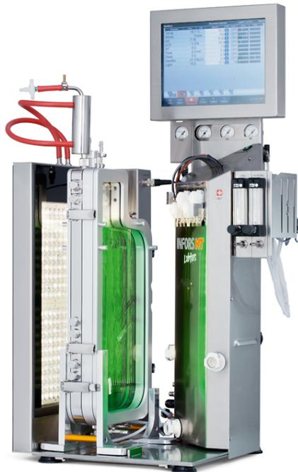
**Abbildung A.3:** Darstellung des Aufbaus eines Labfors 5 Lux Flachplatten-Photobioreaktors mit Grundgerät und Bedieneinheit, LED-Paneel sowie Kultivierungsgefäß (Infors HT, Bottmingen, Schweiz).
