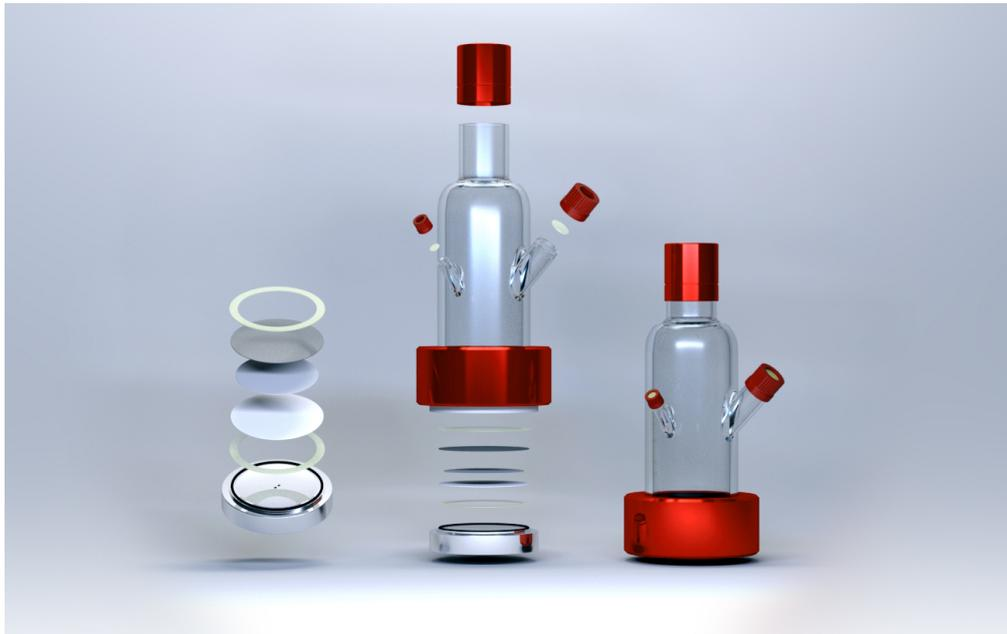
**Abbildung A.1:** Darstellung eines Blasensäulenreaktors (*Rendering*) mit Aufbau des Bodens (links), allen Einzelteilen des Reaktors (Mitte) und dem zusammengesetzten Blasensäulenreaktor (rechts).
