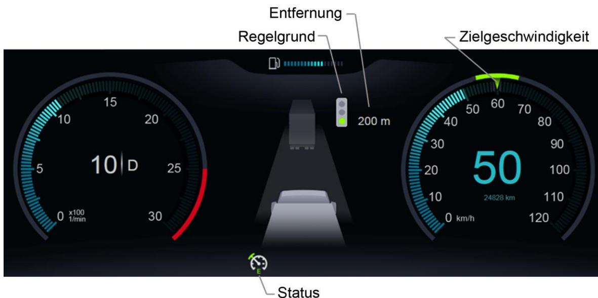
Abbildung 5-10: Optimiertes Anzeigeconcept mit hoher Detailgenauigkeit und hohem Funktionsumfang
