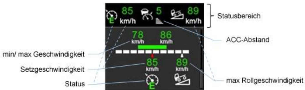
Abbildung 2-13: Anzeige im Kombidisplay zur prospektiven Regelung auf Topographie von Scania; auf Basis von [Sca16]
