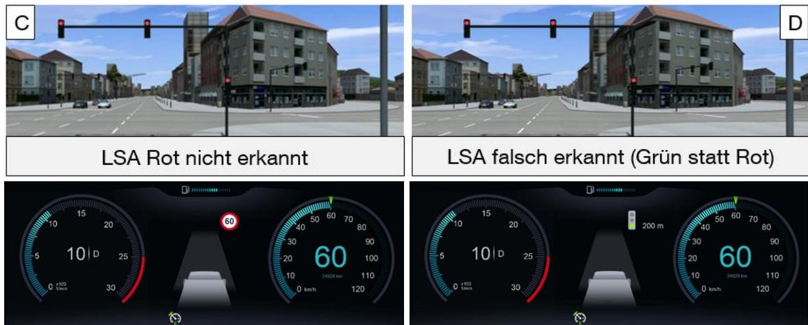
Abbildung 6-7: Potentiell kritische Testszenarien bei Regelung auf dynamische Infrastrukturelemente; Szenario C: „LSA nicht erkannt“; Szenario D: „LSA falsch erkannt“
