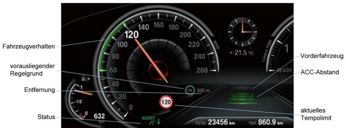
Abbildung 2-17: Anzeige zur prospektiven Regelung auf statische Infrastrukturelemente im Pkw von BMW Speed Assist; auf Basis von [Kno16, S. 20]
