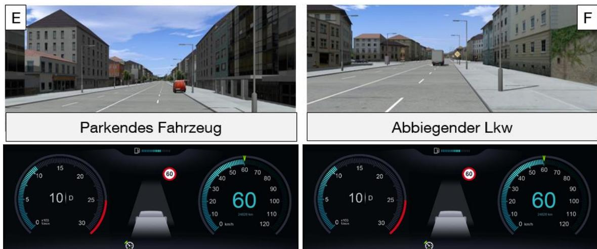
Abbildung 6-8: Potentiell kritische Testszenarien bei Regelung auf Umgebungsverkehr; Szenario E: hereinragendes, parkendes Fahrzeug; Szenario F: hereinragender, abbiegender Lkw
