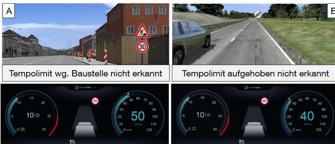
Abbildung 6-6: Potentiell kritische Testszenarien bei Regelung auf statische Infrastrukturelemente; Szenario A „Tempolimit nicht erkannt“; Szenario B „Tempolimit aufgehoben nicht erkannt“
