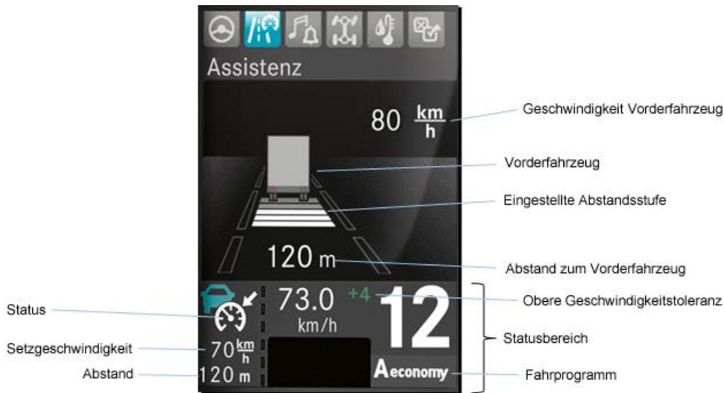
Abbildung 2-14: Anzeige im Kombidisplay zur prospektiven Regelung auf Topographie Daimler; auf Basis von [Aya12]
