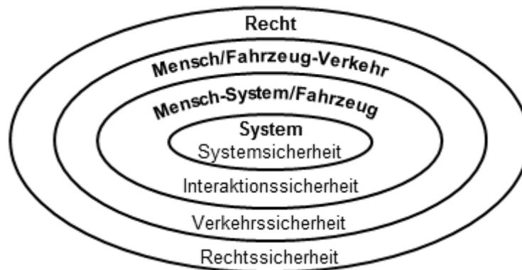
Abbildung 2-10: Betrachtungsebenen für die Sicherheit von Fahrerassistenzsystemen [Geo95, S. 38; Dor03, S. 18]
