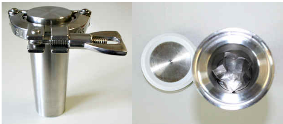
Abbildung 38: Migrationszelle aus Edelstahl mit PTFE-Dichtung im Deckel zur Lagerung Lösemittelhaltiger Proben bei hohen Temperaturen.
