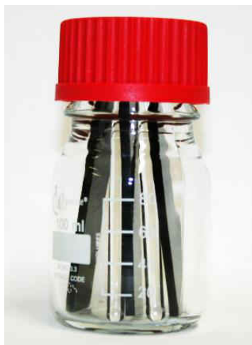
Abbildung 73: Lagerung der Teststreifen in 100 ml Schottflaschen, welche mit Deckeln mit einer Dichtung aus PTFE verschlossen wurden. Glasstäbe dienen als Abstandhalter zwischen den Teststreifen um eine vollständige Benetzung der Nanokomposite zu gewährleisten.
