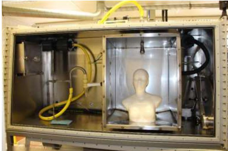
Abbildung 27: Darstellung von Biosicherheits- und Bioaerosolkammer (ohne Frontabdeckung).
