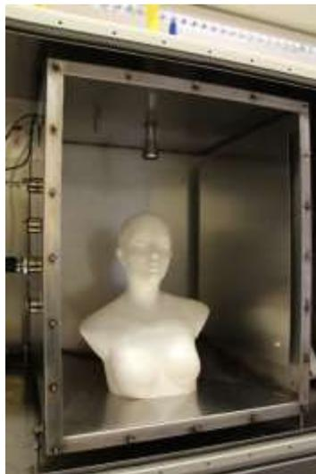
Abbildung 25: Darstellung der Bioaerosolkammer.
