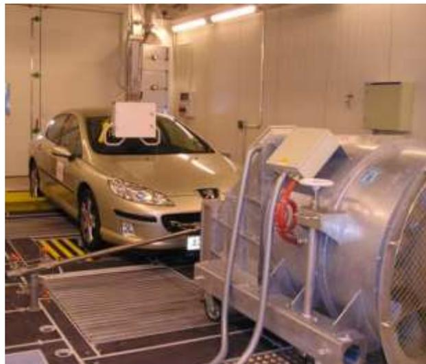
Abbildung 3: Testfahrzeug in Prüfstand [59].
